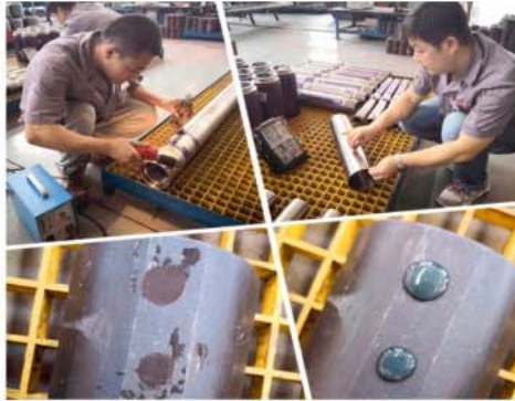
▲ 无损探伤检测/UT&MT
